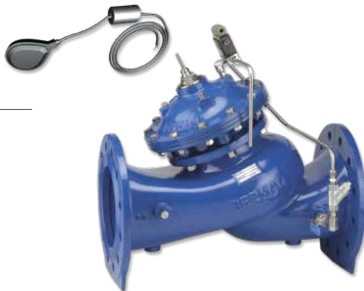
Резервуарный клапан с электромагнитным поплавком для двухуровневого управления модели 750-65 – гидравлически управляемый регулирующий клапан с диафрагменным приводом, который контролирует наполнение резервуара в соответствии с сигналом электромагнитного поплавка. Клапан открывается, когда уровень резервуара достигает минимально заданной величины и закрывается, когда уровень достигает максимально заданной величины.
