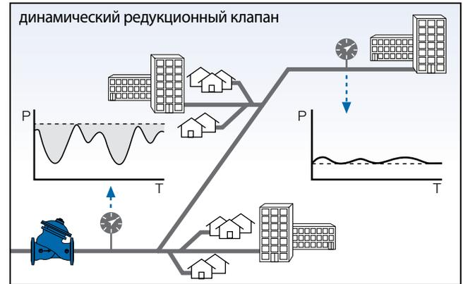
Редукционный клапан управления давлением модели 7PM непрерывно и автоматически регулирует давление на выходе, изменяя настройки на клапане, в соответствии с изменением потребления. В результате среднее давление в системе значительно снижается, и как следствие, уменьшаются потери, аварии, обслуживание и энергозатраты.
