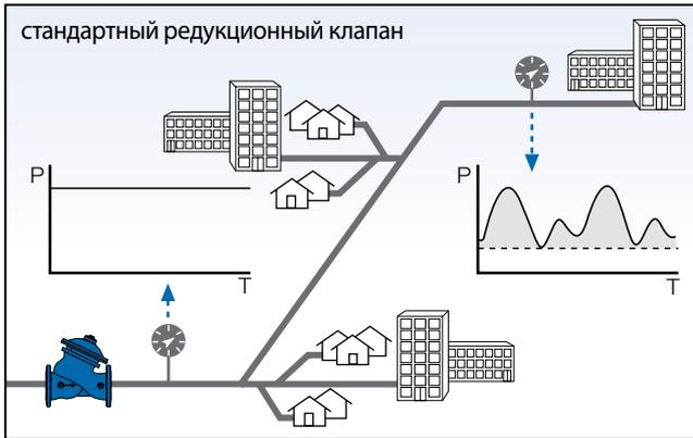
Обычные редукционные клапаны поддерживают постоянное пониженное давление на выходе клапана, обеспечивая достаточное давление в критической точке системы в часы максимального потребления (пиковые точки на графике). Затененной областью на графике отмечено давление выше требуемого.
