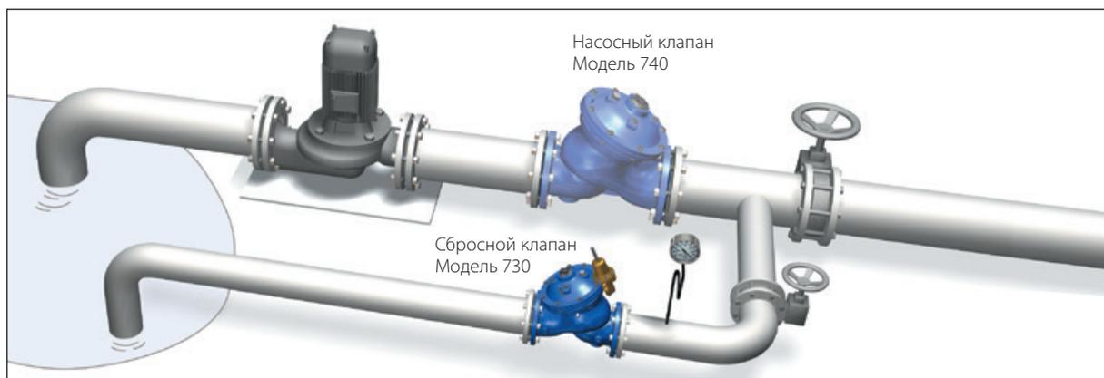
Клапаны, работающие в режиме циркуляции, часто подвергаются сильной кавитации, т.к. разница давлений  $\Delta P$  и скорость потока высокие, в то время как давление на выходе низкое. Как следствие этого, продолжительность работы клапана при этих условиях небольшая. Для повышения срока эксплуатации используют материалы устойчивые к кавитации или устанавливают на входе в сбросной клапан дополнительный редукционный клапан, или подбирают клапан большего диаметра.
